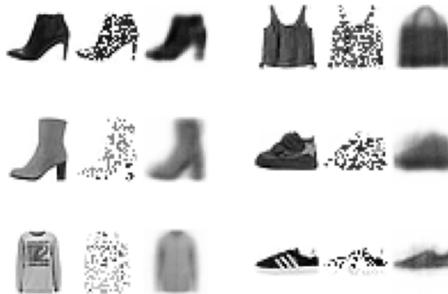
Figura 76: Denoising del DAE entrenado. A la izquierda de cada grupo se muestra la imagen original, en el centro la imagen ruidosa, y a la derecha la imagen reconstruida por el DAE.
